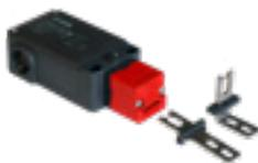
Microinterruttore di sicurezza ad azionatore separato, dotato di elettromagnete di sblocco – versione che consente l'estrazione dell'azionatore ad elettromagnete eccitato – bobina 24 VAC-DC – nr. 2 contatti NC – completo di chiave diritta e piegata.
