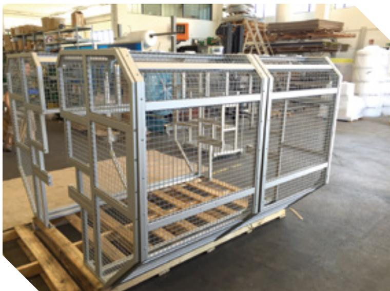
Tecno Più produce sistemi di sicurezza e protezioni a disegno per macchine speciali e bordo macchina, in profilo di alluminio estruso e tamponamenti in materiale plastico antiurto, lamiera o rete. La progettazione, se non fornita direttamente, è sviluppata in collaborazione con il committente per soddisfare ogni esigenza, dalla più semplice alla più complessa.
