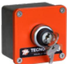
Pulsantiera ad un operatore, con selettore a due posizioni stabili 0 – 1 a chiave estraibile, con nr. 1 contatto NC, IP65
