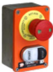
Pulsantiera a due operatori, con pulsante marcia-arresto+spia led 12/30 V ac-dc (nr. 1 contatto NC + nr. 1 contatto NO) – Pulsante di emergenza a fungo (nr.1 contatto NC) – etichetta gialla Ø60 “Emergenza”, IP65
