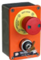
Pulsantiera a due operatori, con selettore a due posizioni stabili 0 – 1 a chiave estraibile, (nr.1 contatto NC) – Pulsante di emergenza a fungo (nr.1 contatto NC) – etichetta gialla Ø60 “Emergenza”, IP65
