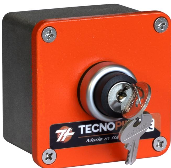
Pulsantiera ad un operatore, con selettore a due posizioni stabili 0 - 1 a chiave estraibile, con n°1 contatto NC.
