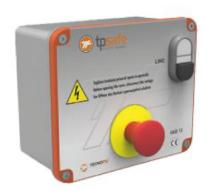
Kit per macchine generiche in cassetta di alluminio pressofuso, equipaggiata con protezione contro i cortocircuiti e sovraccarichi di corrente. Completa di contattore, relè termico di sicurezza a ripristino automatico, trasformatore 400/24 VAC, n°2 fusibili protezione circuiti ausiliari, pulsante di emergenza a fungo e doppio pulsante di marcia-arresto, con spia di presenza rete. Per macchine con assorbimento Max = 5KW, alla tensione di 400V.
