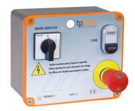
Kit per macchine generiche in cassetta di alluminio pressofuso. Completo di contattore, trasformatore 400/24 VAC, n°2 fusibili protezione circuiti ausiliari, pulsante di emergenza a fungo e pulsante di marcia-arresto, con spia di presenza rete e interruttore generale. Quadro per macchine con assorbimento Max = 5KW, alla tensione di 400V.
