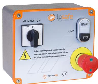
Kit per macchine generiche in cassetta di alluminio pressofuso. Completo di contattore, trasformatore 400/24 VAC, n°2 fusibili protezione circuiti ausiliari, pulsante di emergenza a fungo e pulsante di marcia-arresto, con spia di presenza rete, interruttore generale e relè termico. Quadro per macchine con assorbimento Max = 5KW, alla tensione di 400V.
