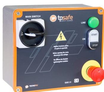
Kit per macchine di piccole dimensioni (es. levigatrici, molatrici o piccole troncatrici a disco), in cassetta di alluminio pressofuso. Completo di interruttore generale, n. 2 contattori, trasformatore 400/24 VAC, **dispositivo elettronico freno motore con iniezione DC (esclusivo Tecno Più)**, n. 4 fusibili, pulsante di emergenza a fungo doppio e pulsante marcia-arresto con spia avvio motore, spia di presenza rete.
